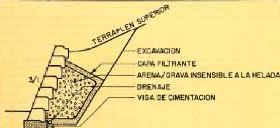
FIGURA - 9. MURO DE SOSTENIMIENTO CON BLOQUES MOLDEADOS DE HORMIGÓN
