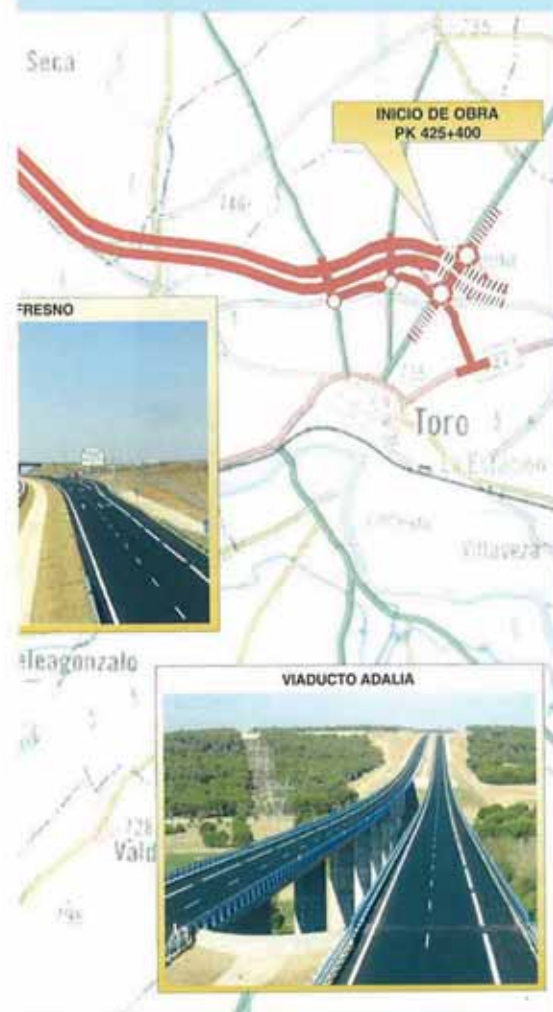
La sección transversal es la característica de una autovía con una mediana de 10 m de anchura.
