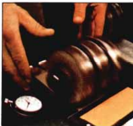
Determinación del tiempo de secado «no-pick-up» en laboratorio.
