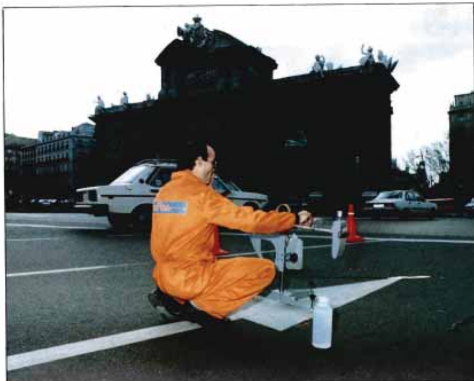
Determinación del coeficiente de resistencia al deslizamiento. SKID RESISTENCE TESTER. Puerta de Alcalá, en Madrid.
