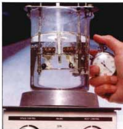
Determinación del punto de reblandecimiento del «SPRAYPLASTIC» (termoplástico en caliente).
