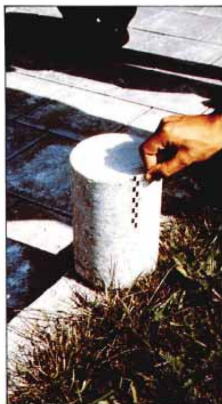
Fig. 16a y b. Junta longitudinal formada en fresco mediante una cuchilla fija fijada a la pavimentadora (autopista A32, R.F. Alemania)
