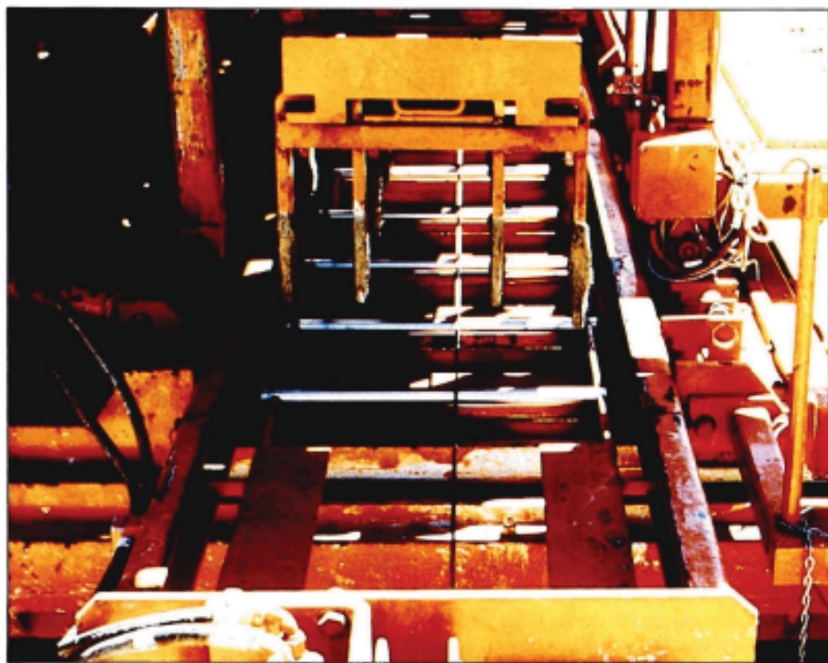
Fig. 13.—Insertador de pasadores acoplado a una pavimentadora de encofrado deslizante (La Guardia-Madrilejos)
