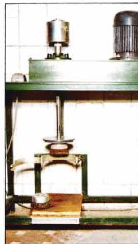
Fig. 22.— Equipo de cepillado rotativo para medir la resistencia a la erosión de materiales con cemento (Instituto Eduardo Torroja)
