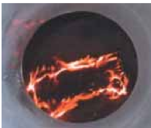
Figura 9 Probeta de mezcla bituminosa durante su ignición
