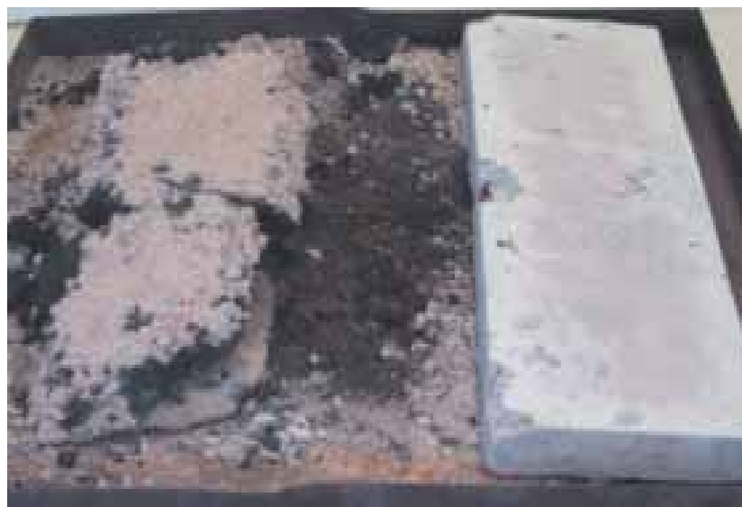
Figura 11 Probetas de mezcla bituminosa (izqda.) y hormigón (dcha.) tras el ensayo
