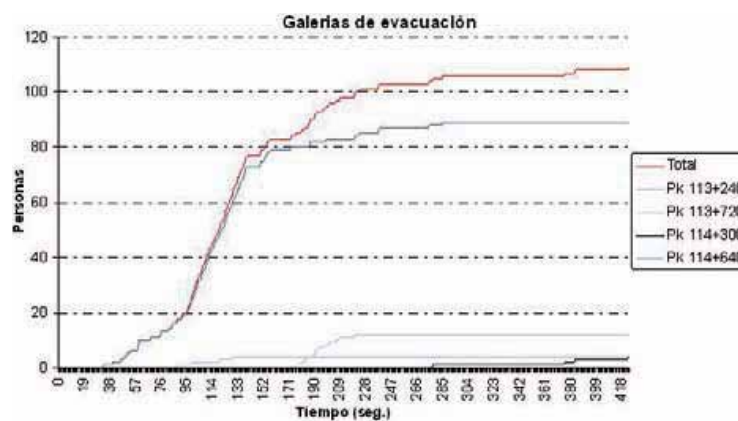
Ilustración 25: Evacuación de los usuarios túnel
