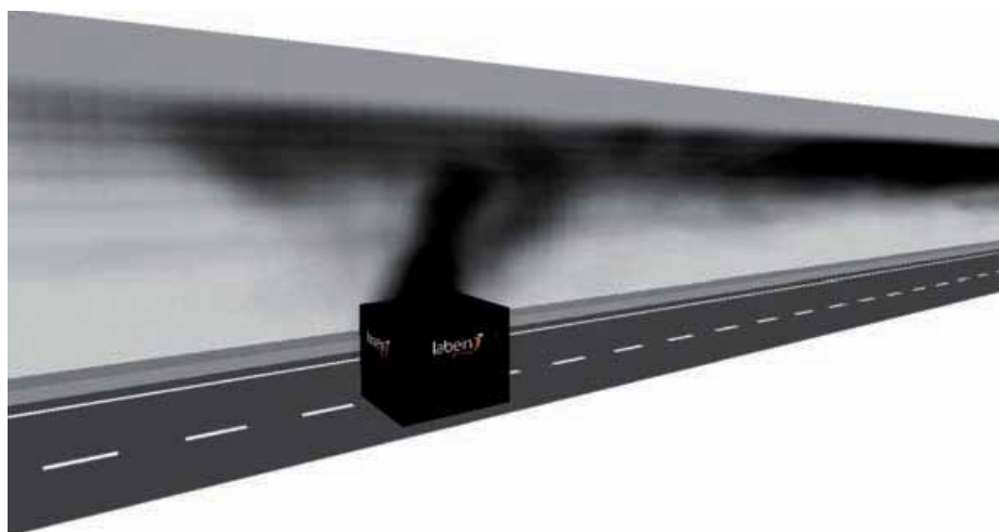
Figura 5: Simulación CFD en túneles. Distribución del humo.
