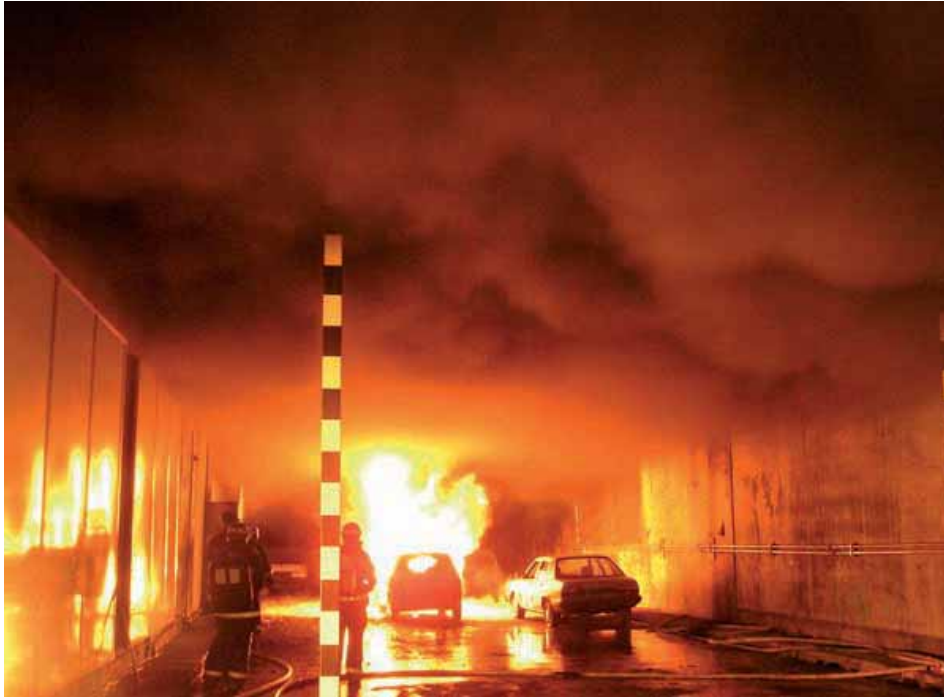
Figura 17.- Realización de uno de los ensayos de incendio a escala real
