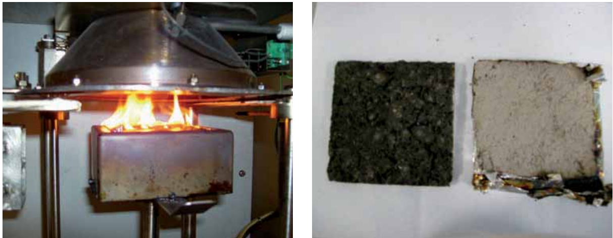
Figura 2. (izq.) Muestra AC16 S en plena ignición durante el ensayo del cono calorimétrico, ((dcha) Muestra antes del ensayo y después del ensayo en el cono calorimétrico.
