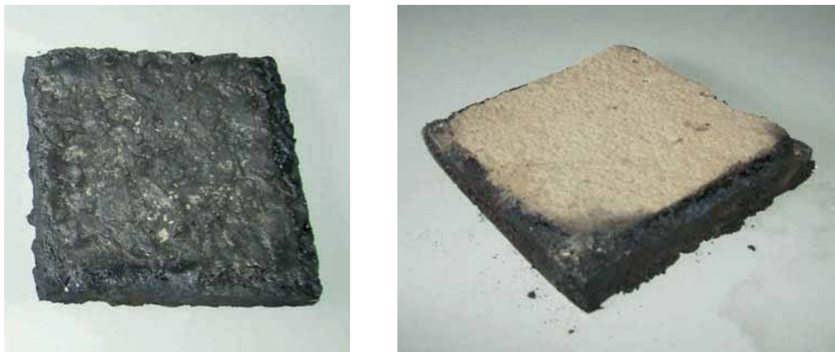
Figura 3: BBTM11A 45/80-65 F OFITA después del ensayo del cono calorimétrico. (izq.) con aditivo retardante a la llama, (dcha.) sin aditivo. llama, (dcha.) sin aditivo. a la llama.
