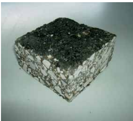
Figura 1. (Izq.) Dispositivo del cono calorimétrico, (dcha) Muestra de 10x10 cm para el cono calorimétrico.
