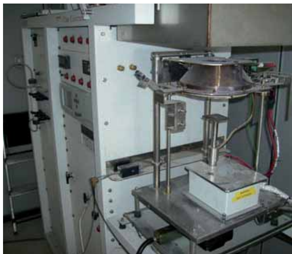
Figura 1. (Izq.) Dispositivo del cono calorimétrico, (dcha) Muestra de 10x10 cm para el cono calorimétrico.
