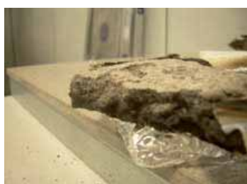
Figura 6. Capa carbonosa creada por la acción del aditivo intumescente
