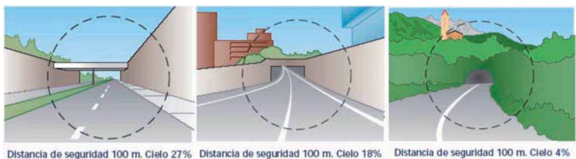
Figura 4.- Algunos de los esquemas para el cálculo de L20 (INDALUX)
