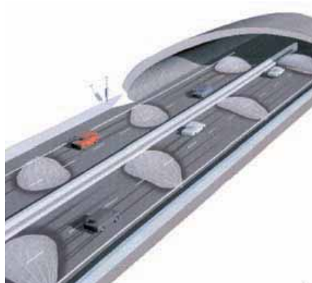
Figura 5.- Sistema de aspersión de fundente químico tipo TMS [BOSCHUNG]
