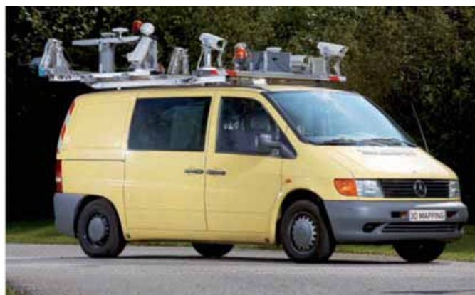
Ilustración 1: El sistema de levantamiento cinemático MoSES que actualmente esta equipado con 8 cámaras, 2 escáneres láser estándar y opcionalmente 2 escáneres láser de alto rendimiento como Zoller&Fröhlich 5006, Leica HDS 6000 o FARO Photon.
