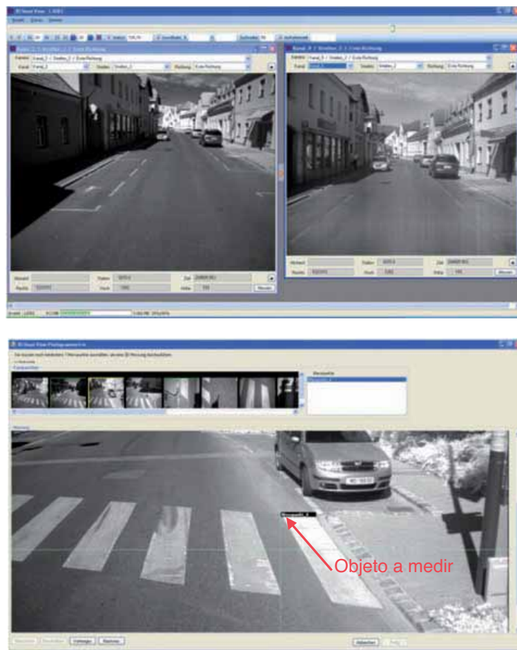
Ilustración 4: Software RoadView para la visualización de las imágenes (arriba) y ventana de medición fotogramétrica (abajo)
