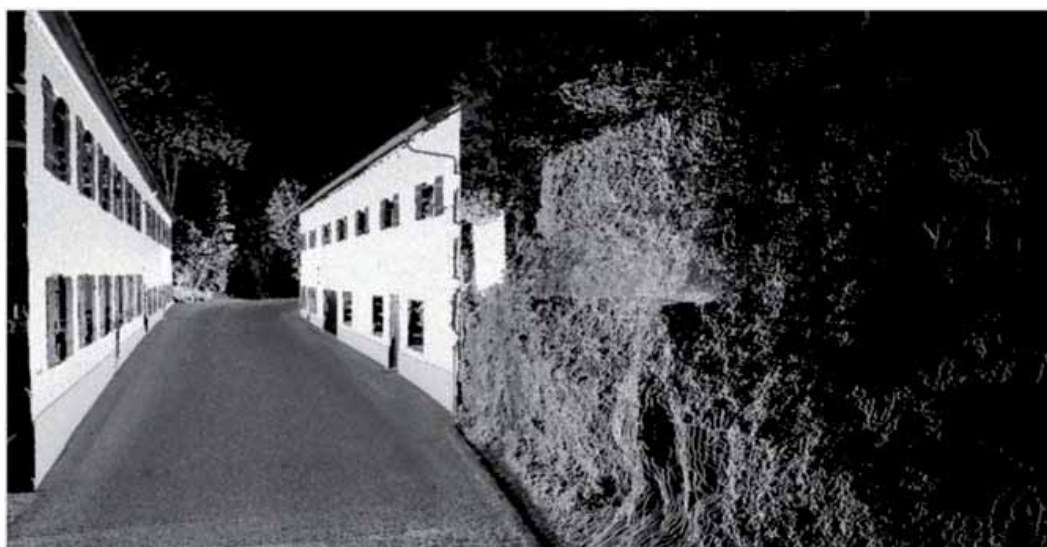
Ilustración 5: Nube de puntos derivada del levantamiento cinemático.
