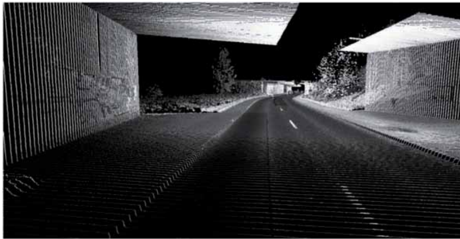
Ilustración 10: Ejemplo de una nube de puntos de un levantamiento de una autovía incluyendo una serie de pasos inferiores.
