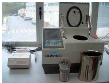
Figura 2: Dispositivo de ensayo de bomba calorimétrica
