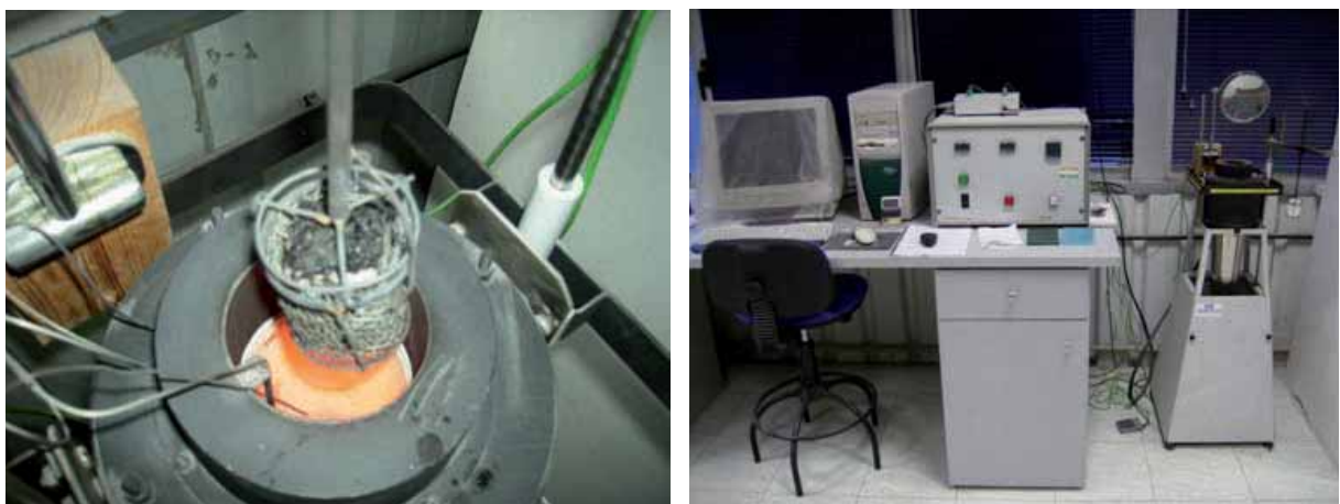
Figura 1: (Izq.) Muestra de aglomerado introduciéndose en el horno de no combustibilidad, (Dcha) Dispositivo de ensayo de no combustibilidad.
