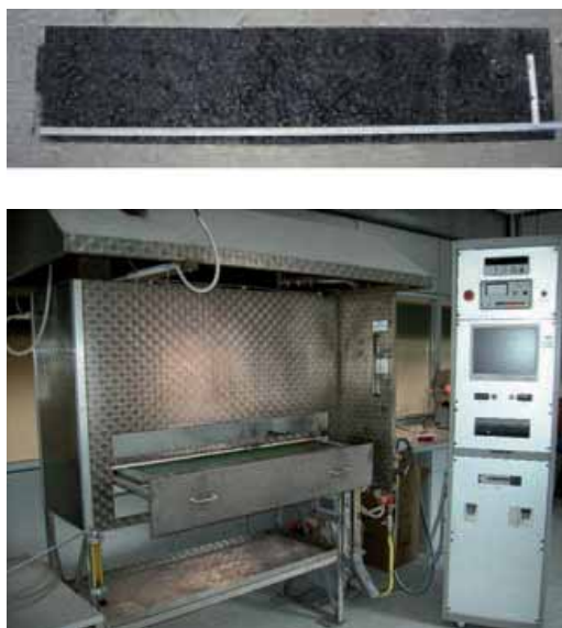
Figura 4. (arriba) Muestra de una mezcla bituminosa para el ensayo del panel radiante. (abajo). Dispositivo panel radiante.
