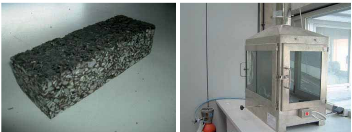
Figura 3. (Izq.) Probeta de mezcla asfáltica para el ensayo de inflamabilidad, (Dcha.) Equipo de ensayo de inflamabilidad.
