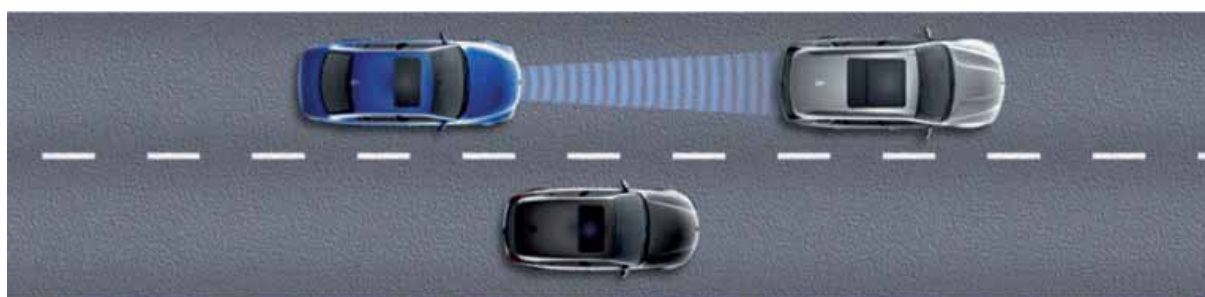
Figura 1: Control de distancia mediante radar
