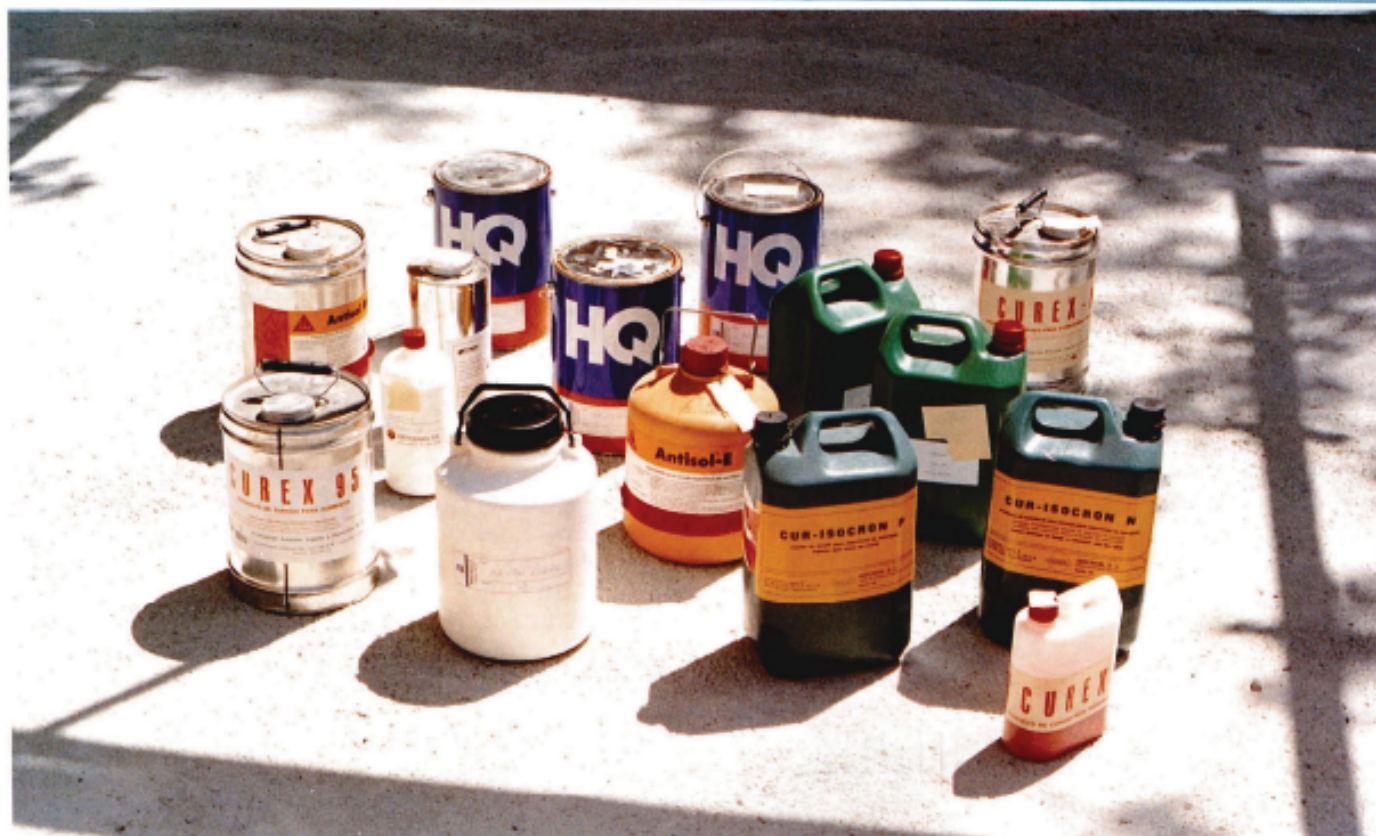
Foto 2. Productos filmógenos para curado del hormigón del mercado español
