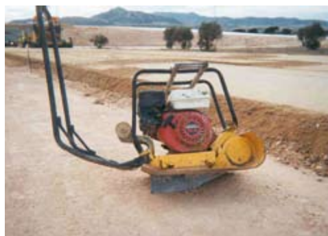
Figuras 4 y 5. Prefisuración con placa vibrante e introducción manual de la emulsión.
