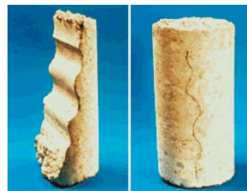
Testigo extraído de una junta realizada con el sistema de juntas activas.
