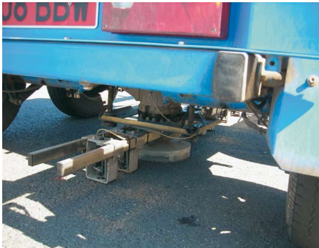
Placa de carga y geófonos del deflectómetro Dynatest.
