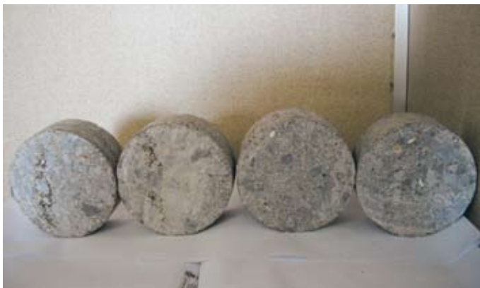
Extracción de testigo y serrado en zona de junta Craft.
