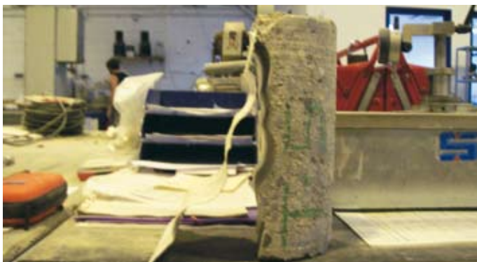
Extracción de testigo y serrado en zona de junta Craft.
