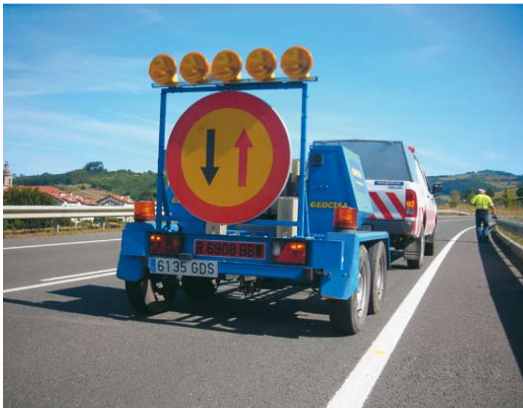
Deflectómetro de impacto DYNATEST HWD 8081.
