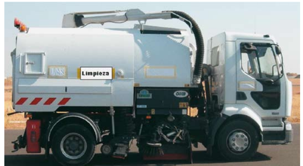
Barredora-aspiradora para eliminar el material suelto tras la compactación.
