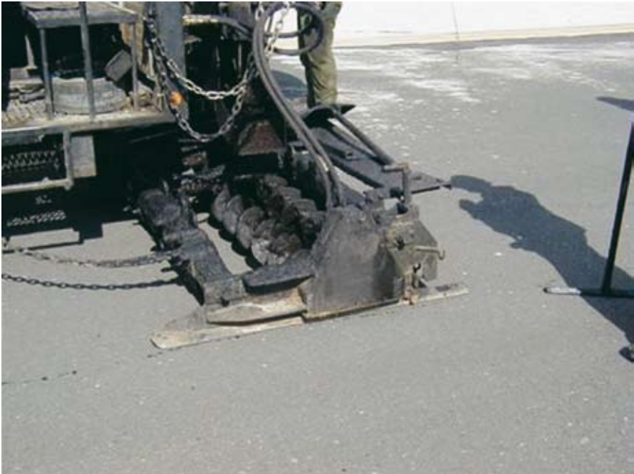
La rastra de extendido. El segundo componente del equipo de aplicación.
