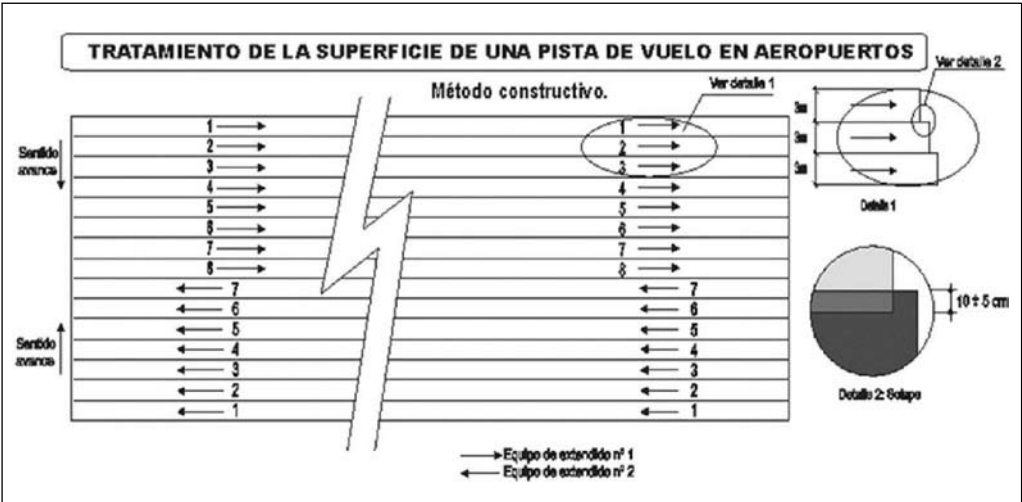
Detalle de los solapes en la ejecución.
