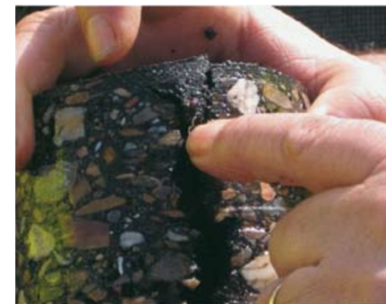
Hay aplicaciones que requieren lechadas muy fluidas para aplicaciones de relleno de grietas. LB-4 en aeropuertos.
