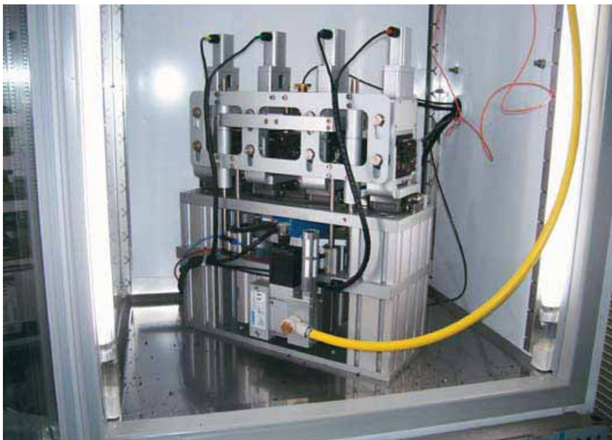
Ensayo de fatiga de probetas prismáticas con cuatro puntos de fijación.
