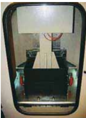
Dispositivo de compactación mediante rodillo de acero.
