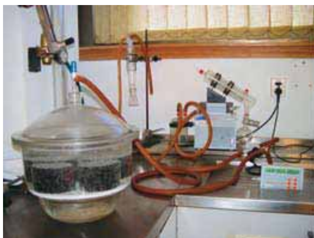
Dispositivos de saturación y rotura de las probetas.
