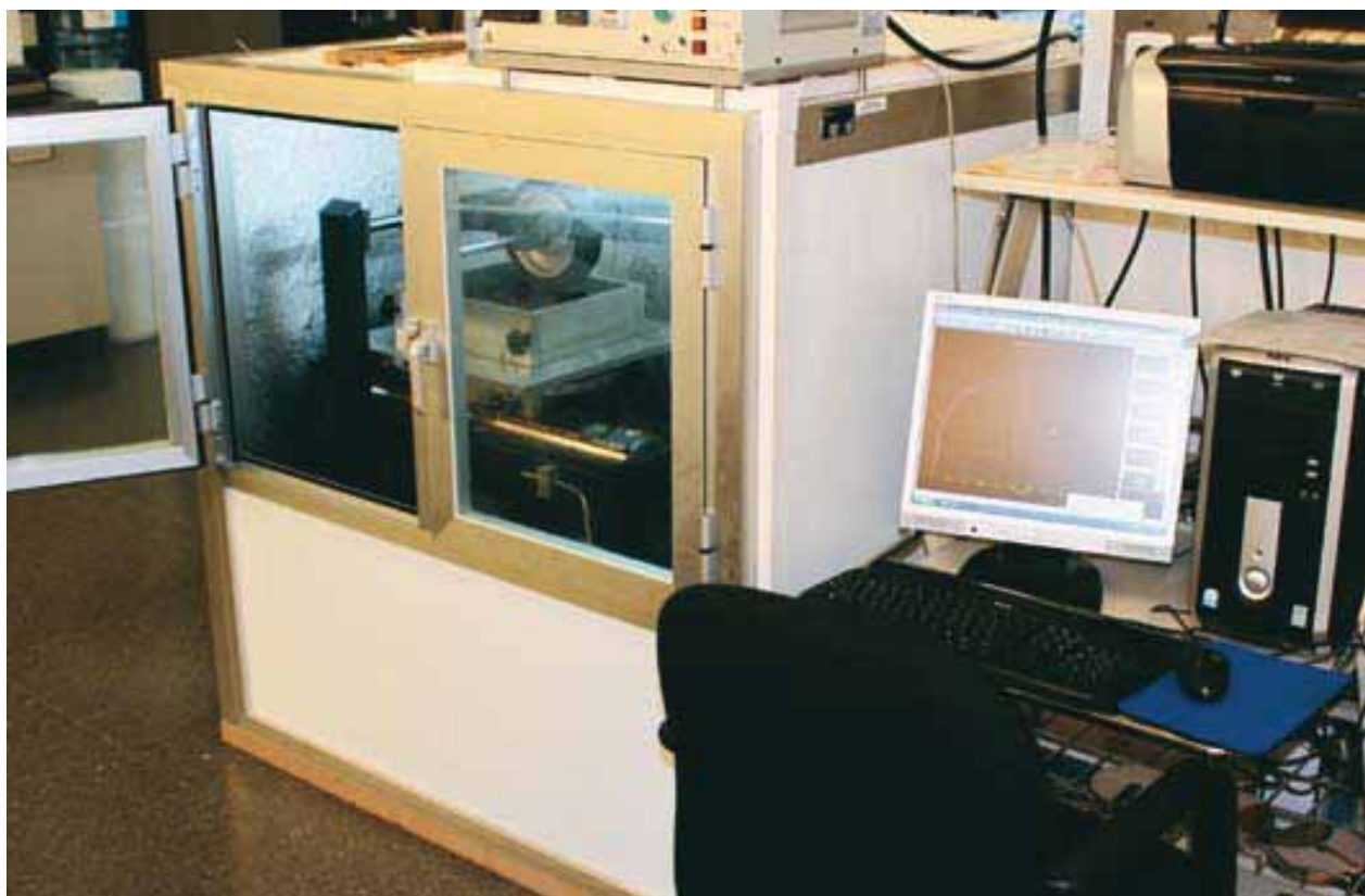
Dispositivo de ensayo en pista de laboratorio.
