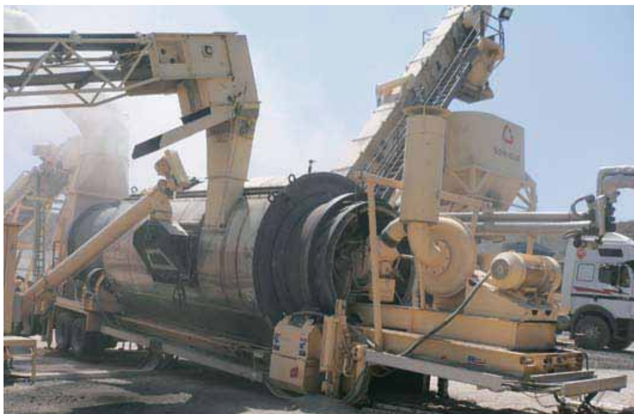
5. Instalación asfáltica de tipo continuo con tambor secador mezclador de tipo Double Barrel.
