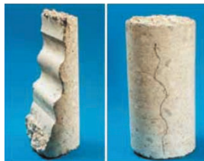
Testigo extraído de una junta con el sistema de juntas activas.
