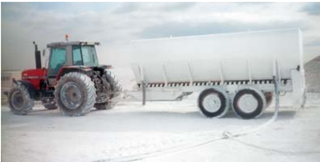
figura 2: Extendedora con dosificador servodirigido con control ponderal para vía seca (fuente SOLTEC)
