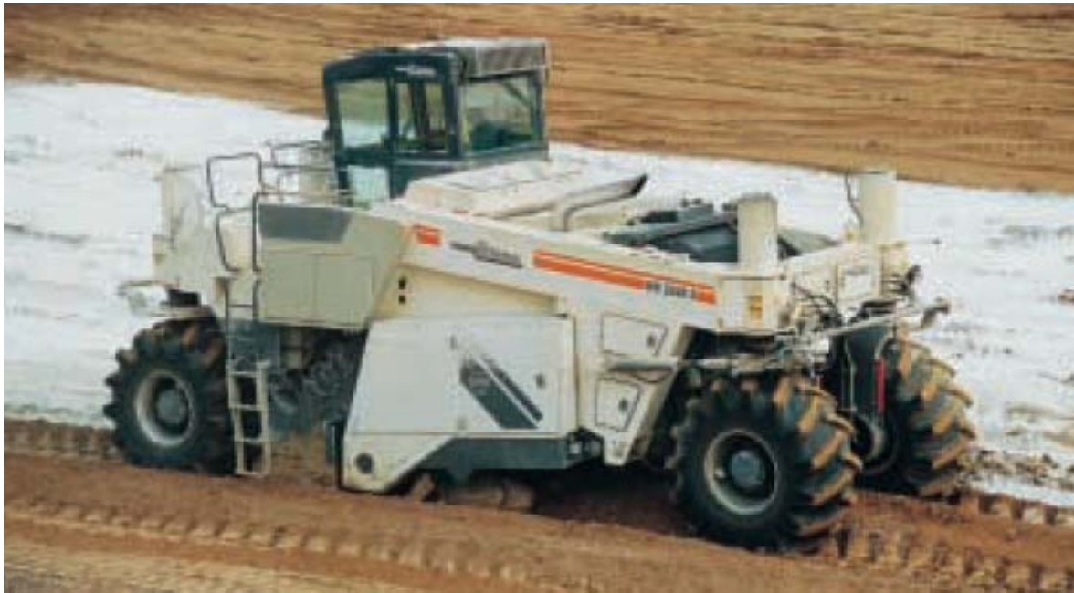
figura 4: Pulvimezclador Wirtgen (fuente Wirtgen)
