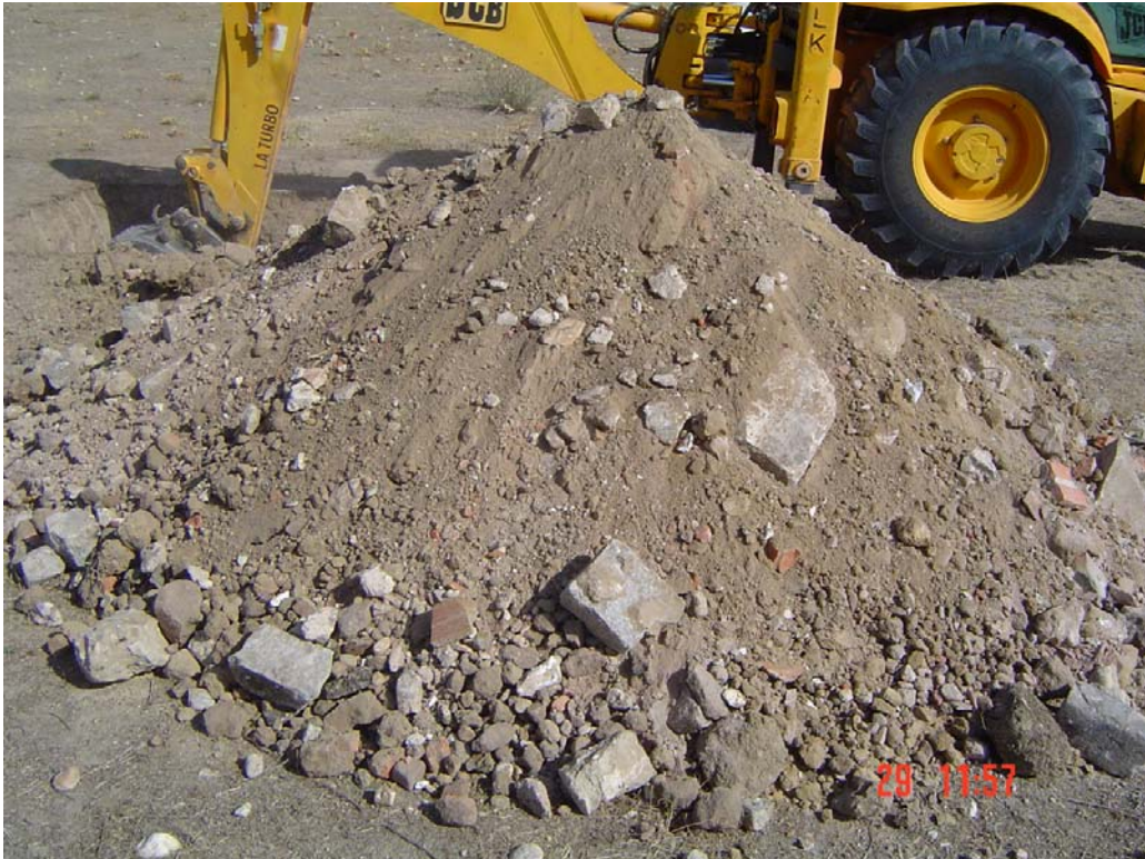
figura 7. Vista de una cata donde el material es predominantemente arenoso con menor presencia cascotes grandes
