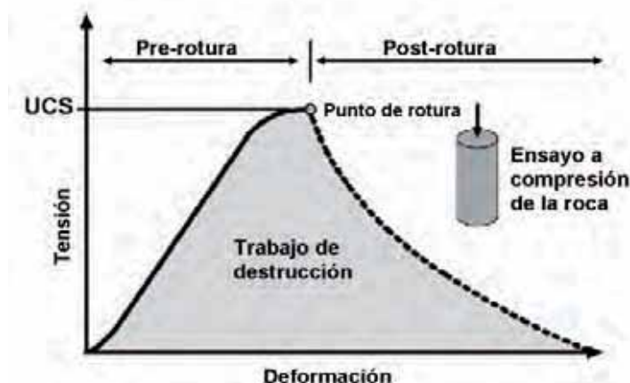
Figura 14. Determinación del trabajo específico de destrucción W_z
