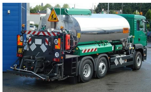
Figura 17. A la izquierda, cisterna de riego. A la derecha, detalle de los abanicos
