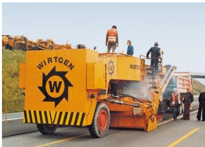
Figura 14. Fresadoras en frío. Carga trasera (izda) y delantera (dcha)
