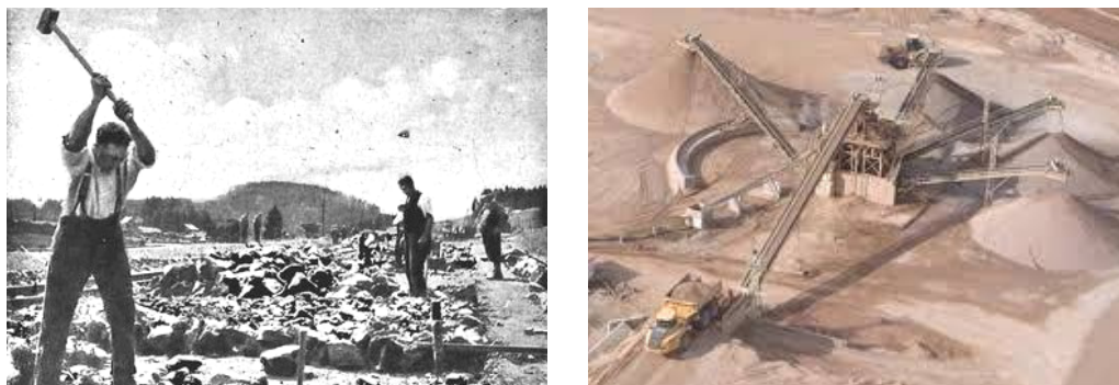
Figura 2. Evaluación de la técnica de machaqueo. A la izquierda machaqueo manual, a la derecha, instalación de machaqueo actual
