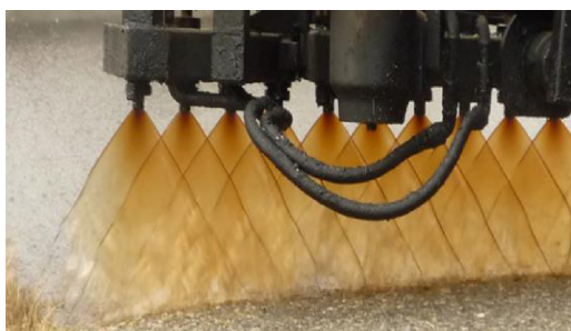
Figura 17. A la izquierda, cisterna de riego. A la derecha, detalle de los abanicos
