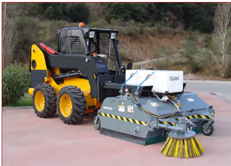
Figura 3. Minicargadora con implementación de equipo de barrido (minibarredora)
