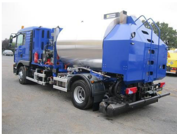
Figura 9. Cisterna con rampa de riego.
