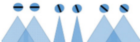
Figura 9. Efecto orientación de boquillas en riego de liga Fuente: Asphalt Institute, 2014
