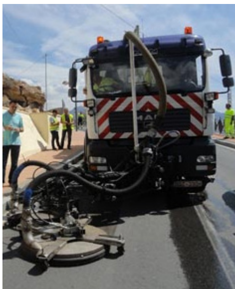
Figura 8. Camión de hidrodesebaste.
