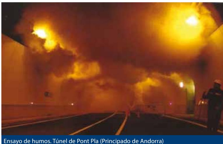
Ensayo de humos. Túnel de Pont Pla (Principado de Andorra)
