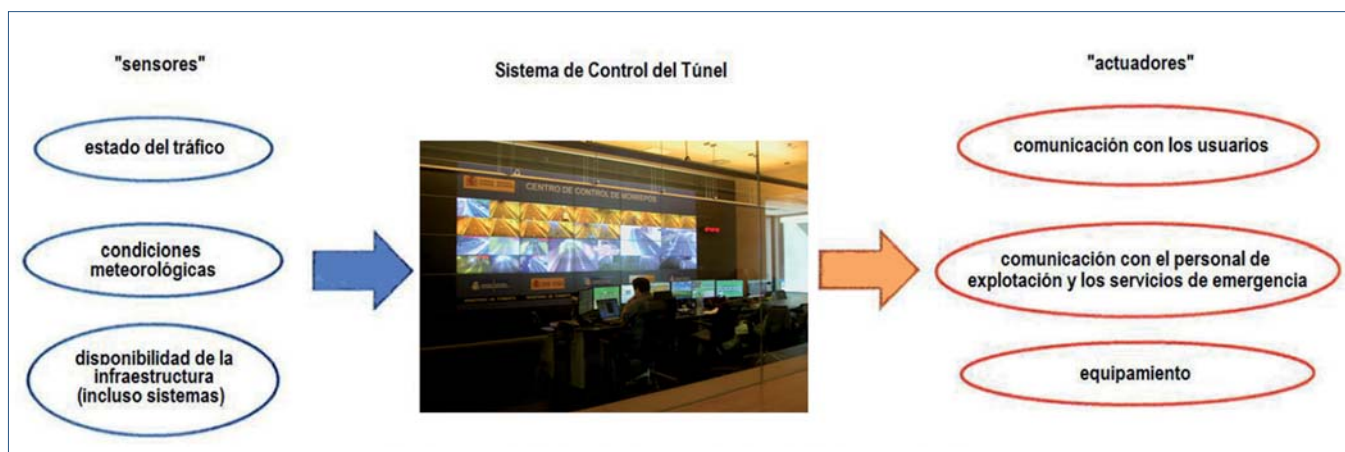
Figura 5. Esquema del sistema de control del túnel
