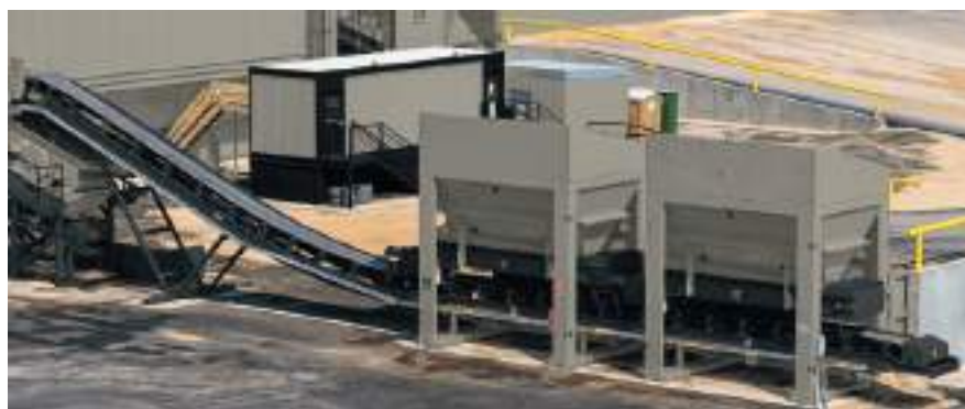
Figura 1. Central de fabricación equipada con dos tolvas para la introducción de RA
