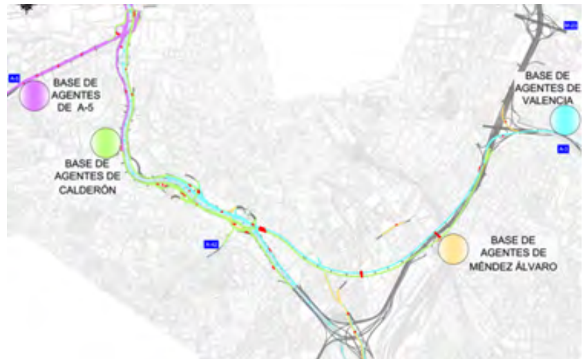
Figura 4. Bases de agentes de primera intervención en los túneles de la M-30
