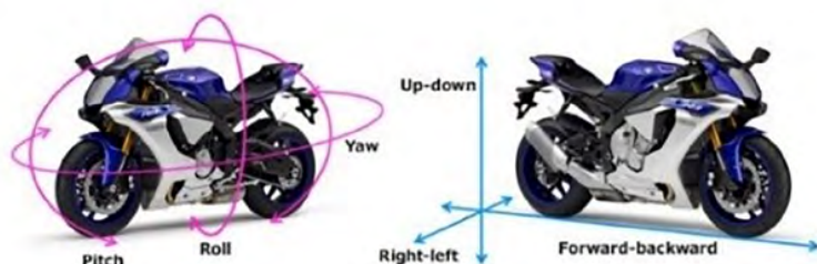
Figura 3. Modelo cinemático de referencia para el análisis de comportamiento del motorista en la vía 13 . Fuente: https://global.yamaha-motor.com/
