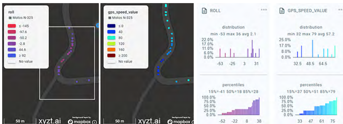
Figura 14. Velocidades y roll en curva de radio 17 metros del usuario 537. Fuente: Datos de moto conectada a través de visor multiparámetro xyzi.
