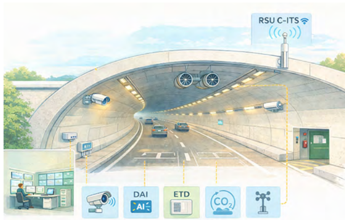
Figura 3. Equipamientos ITS y RSU para un túnel conectado.
