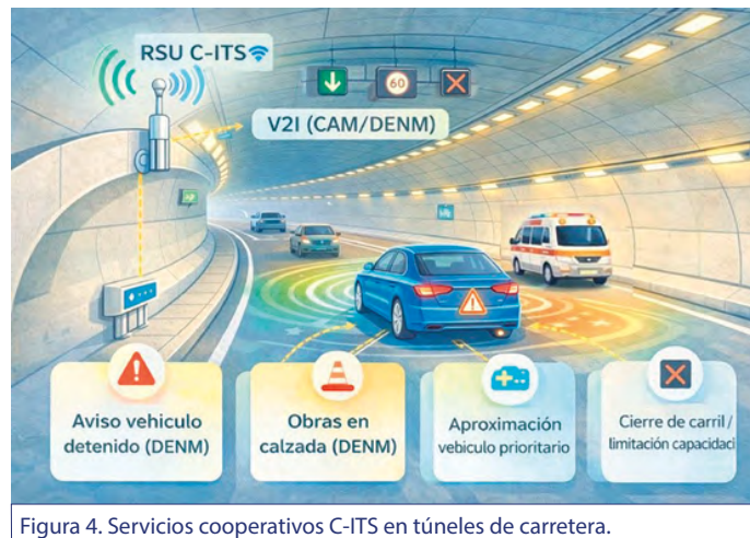
Figura 4. Servicios cooperativos C-ITS en túneles de carretera.
