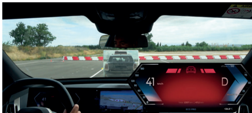
Figura 5. Ejemplo de Funcionamiento AEB. https://www.dgt.es/muevete-con-seguridad/conviertete-en-un-buen-conductor/Sistemas-avanzados-de-ayuda-a-la-conduccion-ADAS-/
