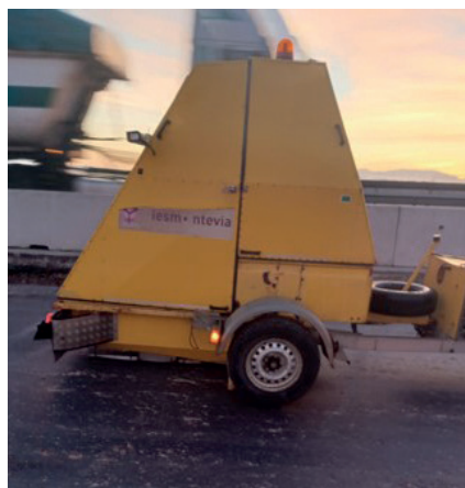
Figura 4. Deflectómetro de impacto auscultando capa de suelo estabilizado S-EST 3.
