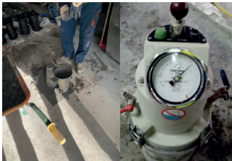
Figura 15. Ensayos de cono de Abrams y aire ocluido, realizados por Gedhosa.
